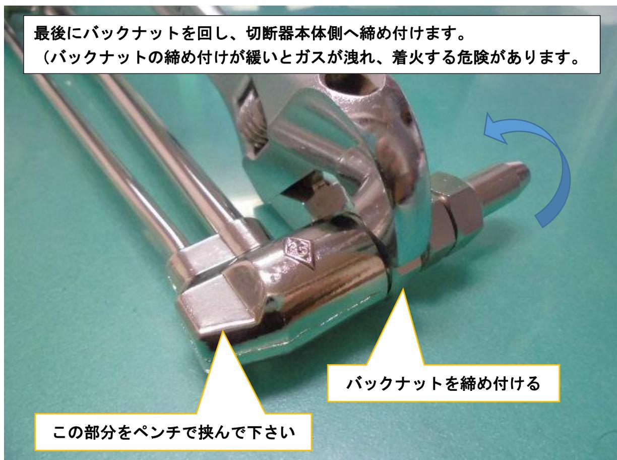
バックナットを締め付ける
