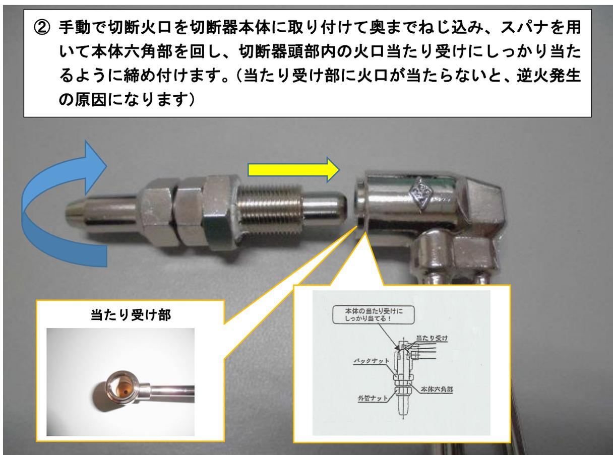
外管ナットでは締め付けしないで下さい！外管ナットで締め付けた場合、外管の芯がぶれ、炎がまっすぐに伸びなくなります。
