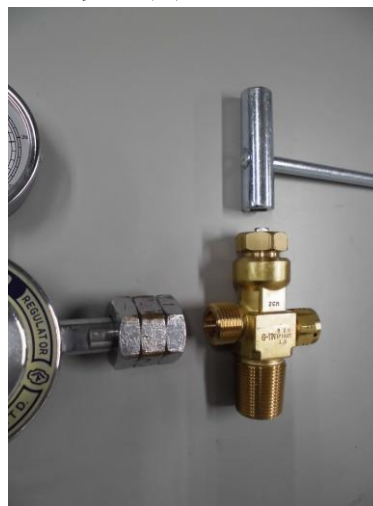
アルゴン調整器＋ソトネジバルブ (パッキンあたり)
